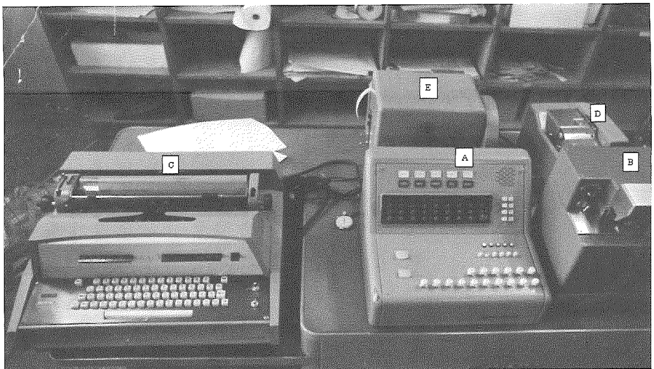
NEAC2101 A: 操作台 B: Photoリーダー C: 電動タイプライター D: 機械式紙テープリーダー E: 紙テープさん孔機
